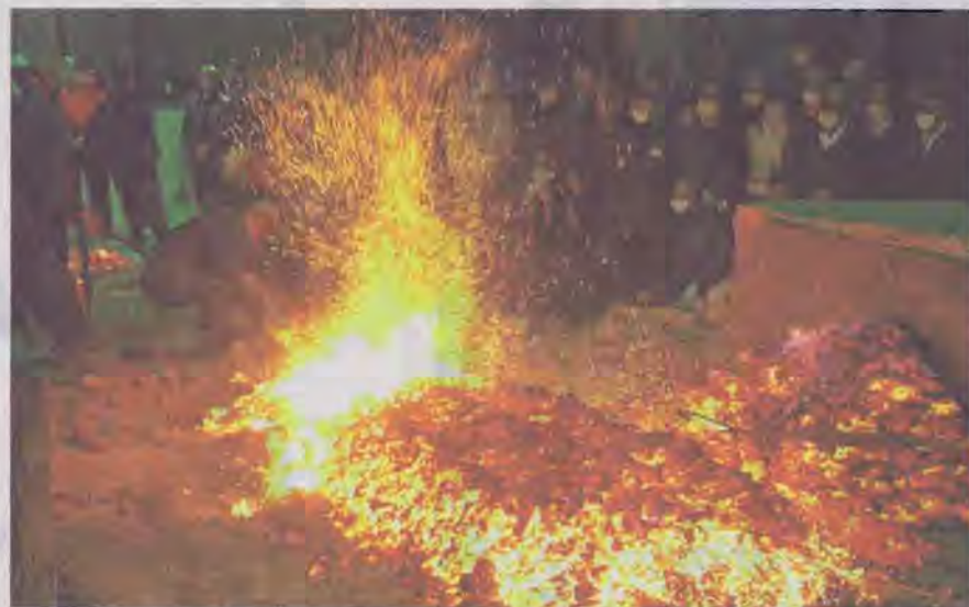
3昼夜のたたら操業を経て、姿を現した鉤(けら—粗鋼)。祖先たちからのメッセージを感じ取れる—島根県奥出雲町大呂の 日刀保たたら、資料
